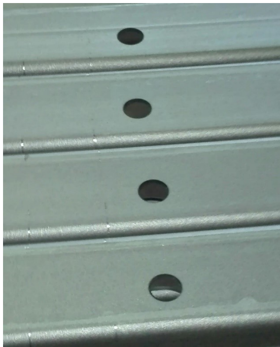
Kuvio 14. Laserilla sinkopuhallettuihin teräksiin tehdyt reiät
