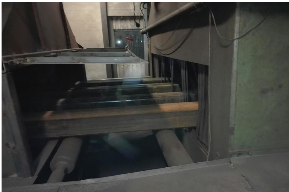
Kuvio 4. Teräkset sinkopuhalluksessa
