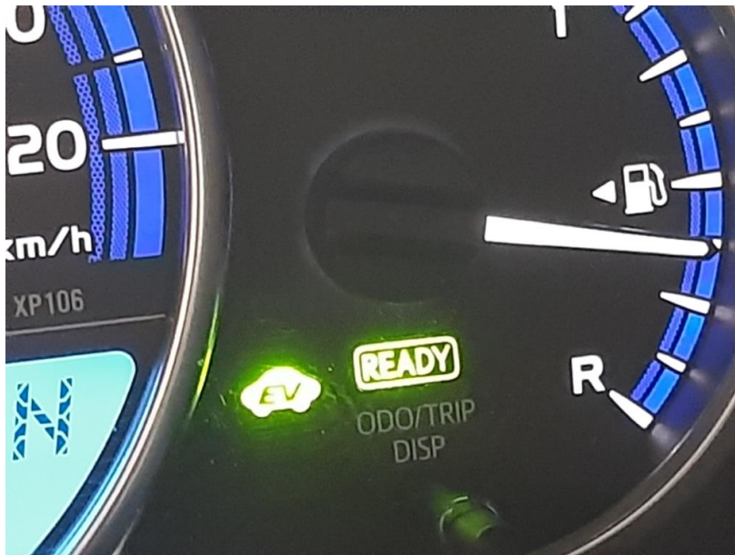
Kuva 3. Toyota Yaris -hybridiajoneuvon merkkivalot, jotka kertovat ajoneuvon olevan valmis liikkumaan sähköllä.
