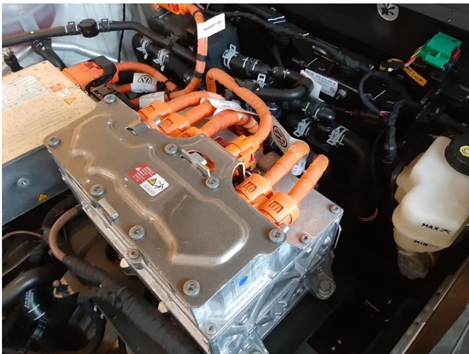
Kuva 2. Korkeajännitekaapeleiden oranssi ulkokuori Volkswagen E-Golf-sähköautossa.
