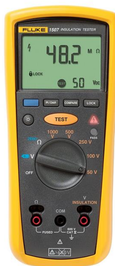
Kuva 4. Fluke 1507 -eristysvastusmittari (Fluke 1503/1507 -eristysvastusmittarit).
