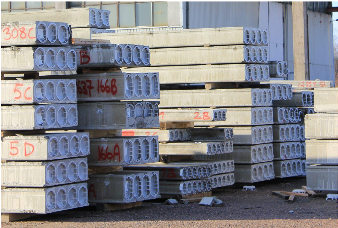
Kuva 3. Ontelolaattoja varastossa (Lujabetoni Oy:n verkkosivut)
