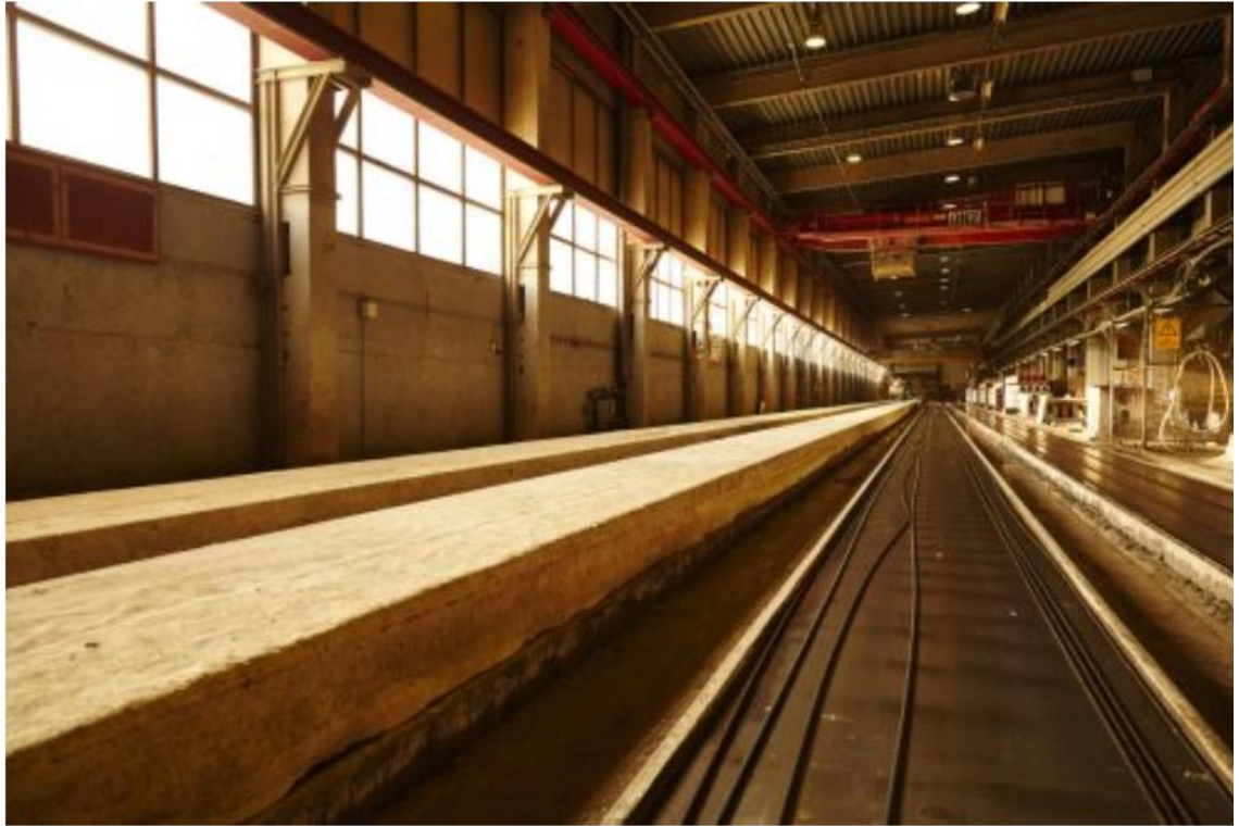
Kuva 5. Ontelopeti löysillä punoksilla ja peitelty ontelovalu (Lujabetoni Oy:n verkkosivut.)
