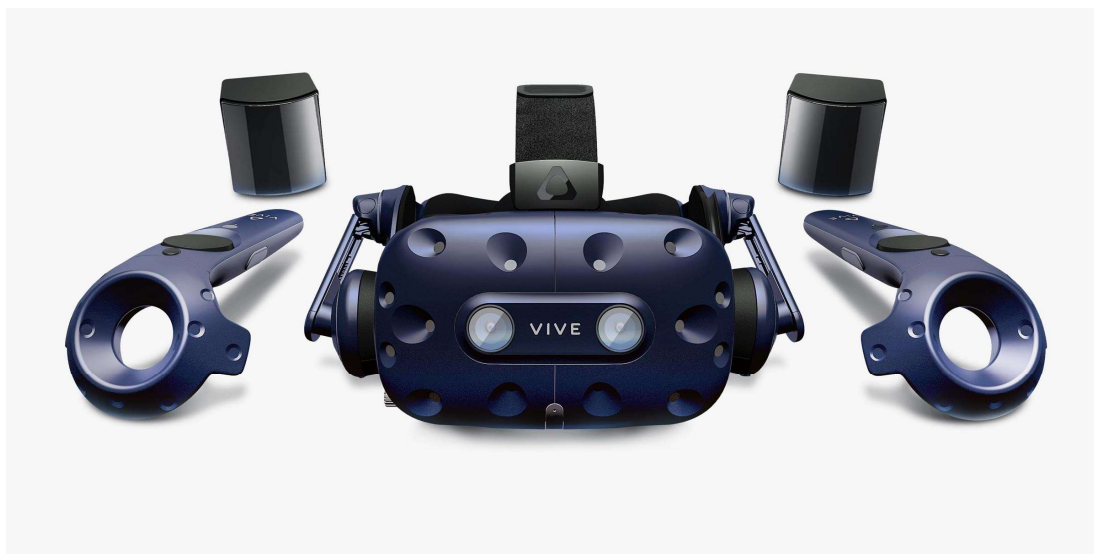
Kuva 1. HTC Vive Pro. Kuvassa majakat, ohjaimet ja lasit. (Wired 2018.)
