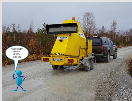
KUVA 19. KANTAVUUDEN KEHITYKSEN SEURANTAA KUAB-LAITTEELLA.
