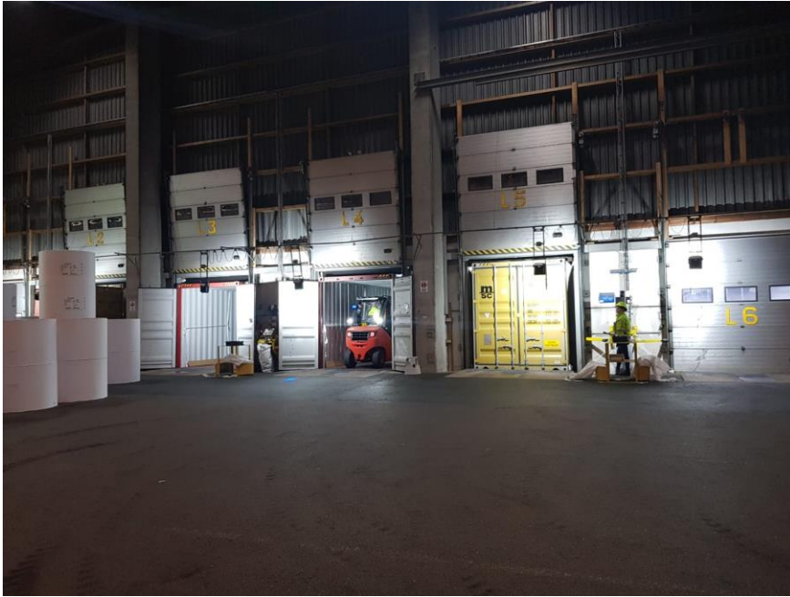
Kuva 15. Nostokyvyltään 3,5 tn oleva trukki lastaa merikonttia.
