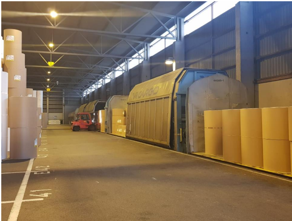
Kuva 13. 5,0 tn nostokyvyltään oleva trukki purkaa junavaunua.
