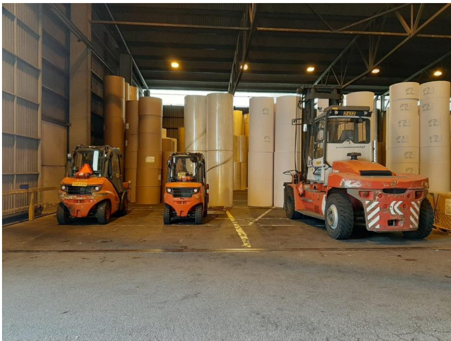
Kuva 17. Vasemmalta oikealle; 5,0 tn, 3,5 tn ja 16,0 tn nostokyvyltään olevat trukit varastohallissa
