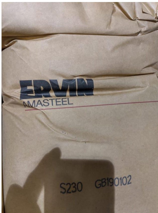
Kuva 13. Ervin AMASTEEL-luokan teräshiekkaa
