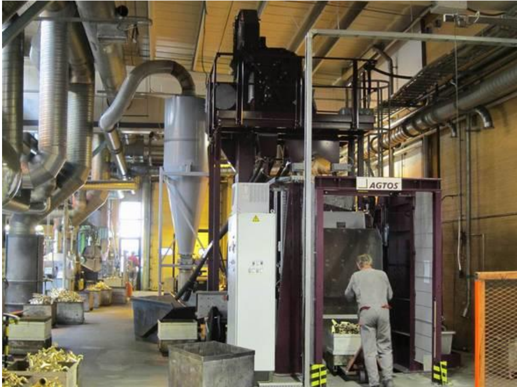
Kuva 4. Oras Oy:n valimolla toimiva AGTOS MR 270 (Agtos www-sivut b )
