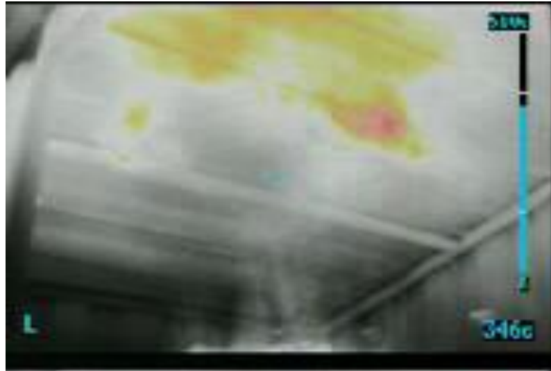
Kuva 15. Toinen polttokoe, palokuorma 100 kg. Kuva on otettu 10 sekuntia jäähtymisen aloituksen jälkeen, lämpötila alkupalon päällä mittauspisteessä lämpökameran antavan arvon mukaan oli 346 °C. Stillkuva on kaapattu lämpökameran videosta.
