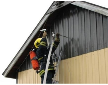
Kuva 27. Ullakkopalon jäähdytys pistosuihkuputkella rakennuksen päätykolmiosta (Mikko Halli).
