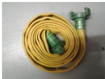
Kuva 29. Komposiittirakenteinen liittimistä värikoodattu kattotyöskentelypaloletku.
