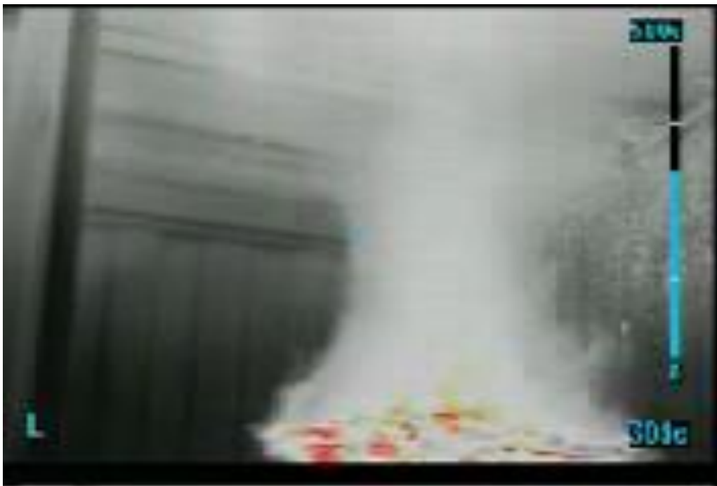
Kuva 11. Ensimmäinen polttokoe, 50 kg palokuorma. Kuva on otettu 10 sekuntia ennen jäähdytyksen aloittamista, lämpötila alkupalon päällä mittauspisteessä lämpökameran antaman arvon mukaan oli 301°C. Stillkuva on kaapattu lämpökameran videosta.
