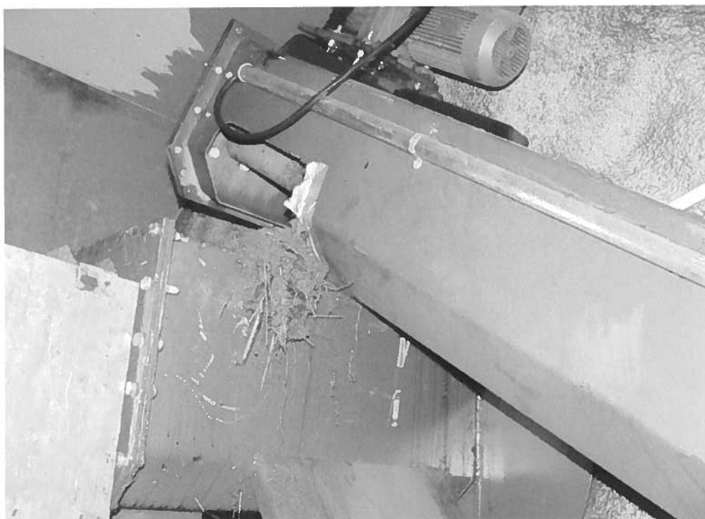
Kuvio 15. Lanta kulkeutuu nostoruuvilla syöttimen kautta rumpukompostoriin.
