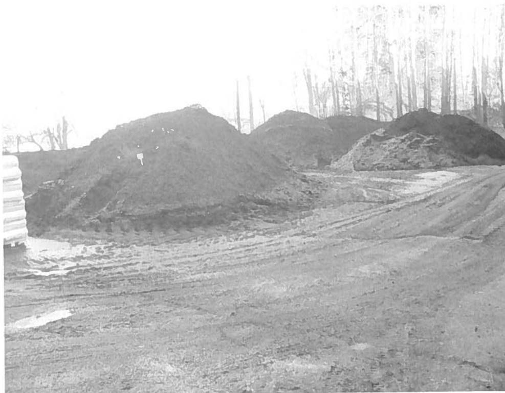
Kuvio 17. Jälkikompostointiaumoja, joista etualalla olevasta hämärästi erottuu erän numerokyltti. Jokainen auma on merkittävä purkusiilosta siirrettäessä.
