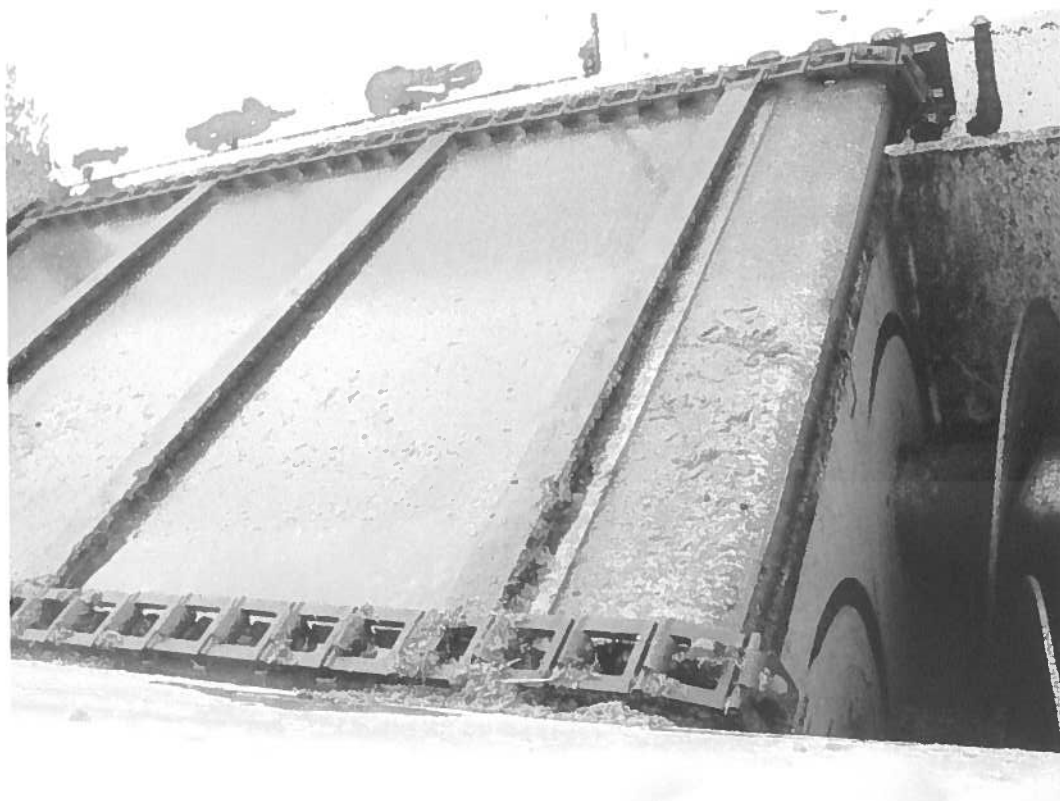
Kuvio 6. Murskan kuljetinpöytä, johon lanta kuormataan. Lanta siirtyy edelleen pakkausruuveihin (vasemmalla).
