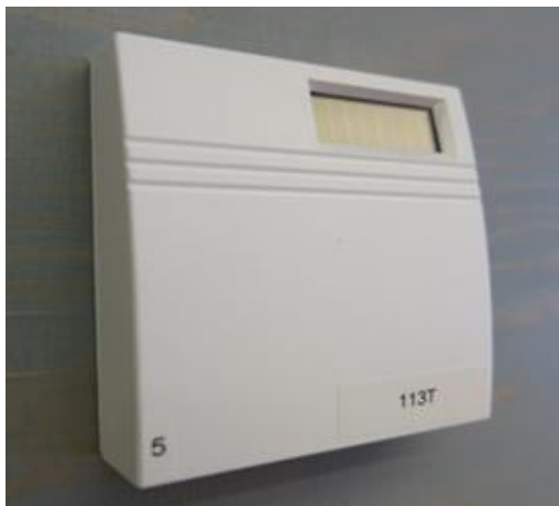
Kuva 8.3. ja kuva 8.4 Valokennolla ja paristolla varustettu langaton EnOcean lämpötila-anturi sekä EnOcean teknologialla langattomasti etäohjattava patteritermostaatti.
