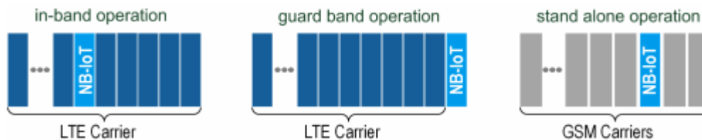
Kuva 4.4. NB-LoT kaistan sijoitus LTE-kaistalle tai GSM-kaistalle (Stand alone). [24]
