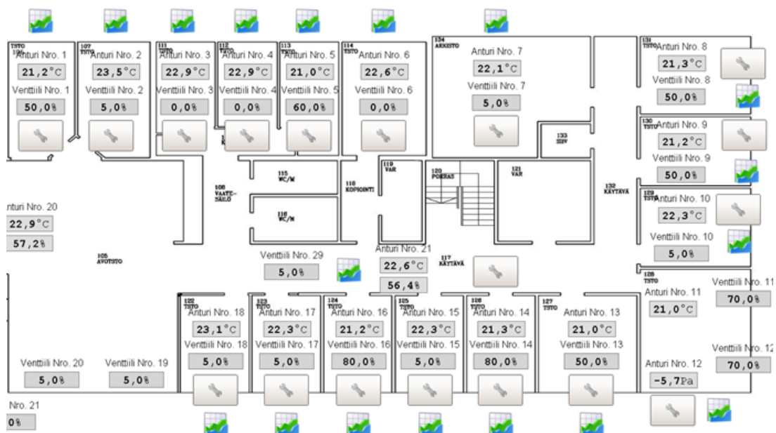
Kuva 8.5. Esimerkki Talotohtorin käyttäjäliittymän etävalvomonäytöstä. Trendikuvake avaa trendinäkömän (vapaa aika-asettelu, sekunti, tunti, vrk). Työkalukuvakkeesta voidaan asettaa mm. yksittäisen patteritermostaatin toimintoja ja hälytysrajoja.
