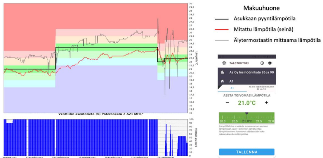
Kuva 8.7. Talotohtori valvomon trendinäkömää lämpötilan muutoksista ja patteriventtiilin asentotiedosta asukkaan asettaman sisälämpötilan pyyntiarvon mukaan, sekä oikealla Talotohtori Home mobiilisovelluksen käyttöliittymä. [82]
