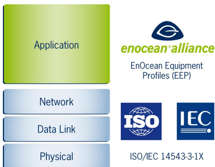
Kuva 5.10. EnOcean protokollapino EPP määrittää sovellustason ja ISO/IEC 14543-3-1X standardi määrittelee muut tasot. [68]
