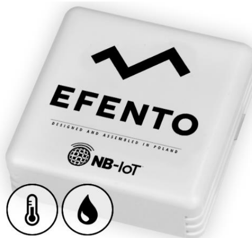
Kuva 4.6. Efento:n valmistama NB-IoT sensori lämpötilan ja kosteuden mit- taamiseen. [41]
