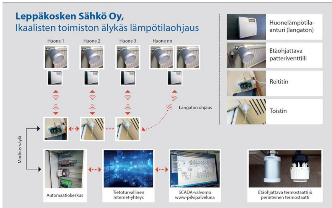
Kuva 8.2. Periaatekuva älykkään lämpötilaohjauksen toteutuksesta.
