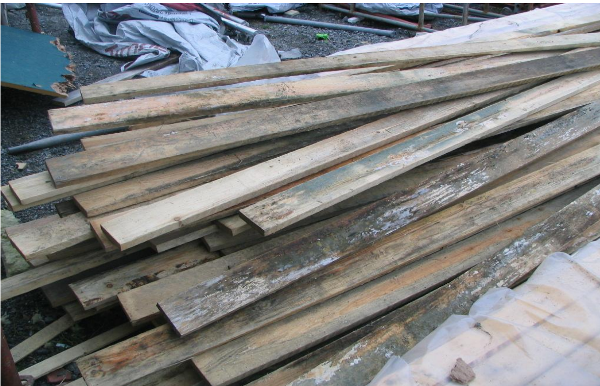
KUVA3: Vääränlaisen varastoinnin takia pilalle menneitä lautoja.
