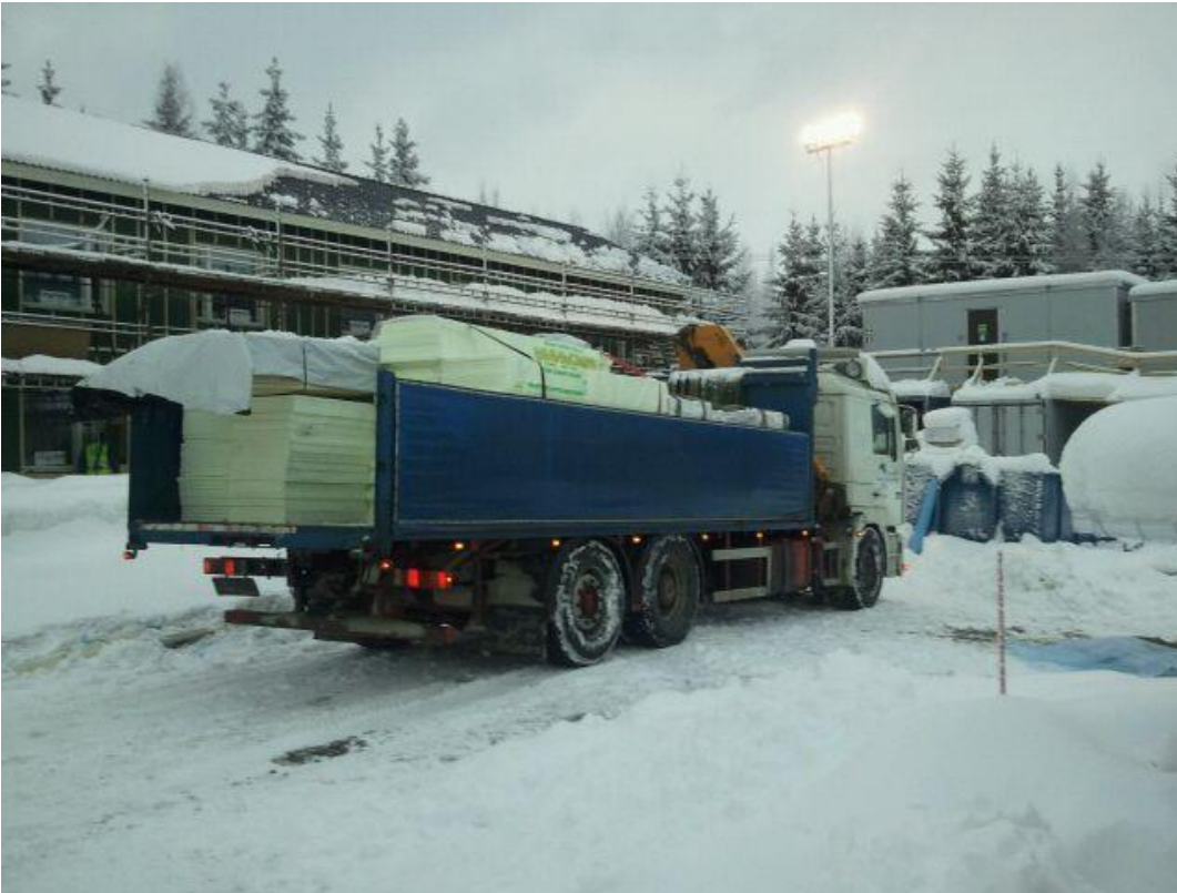
Kuva 6: Kuvassa 2-akselinen kuorma-auto varustettuna omalla nostimella.
