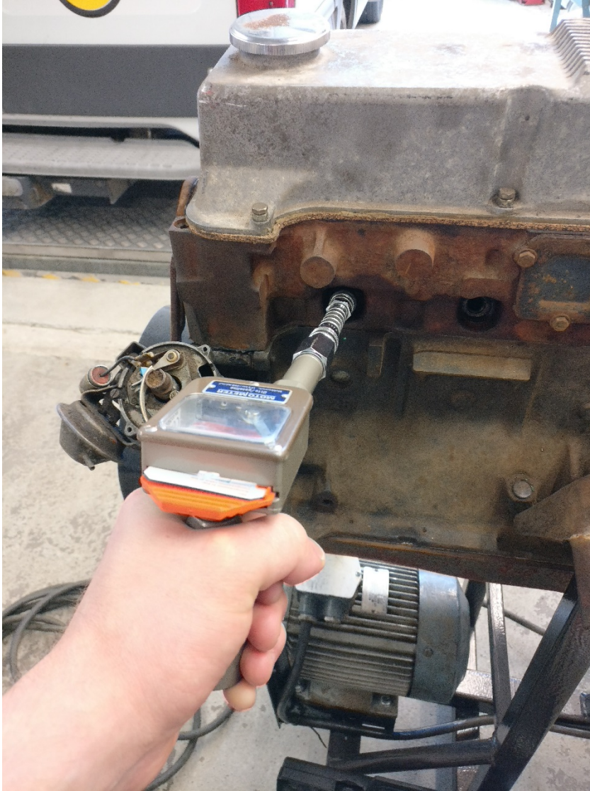
Kuva 10. Puristuspainemittarin asettaminen sytytystulpan reiälle
