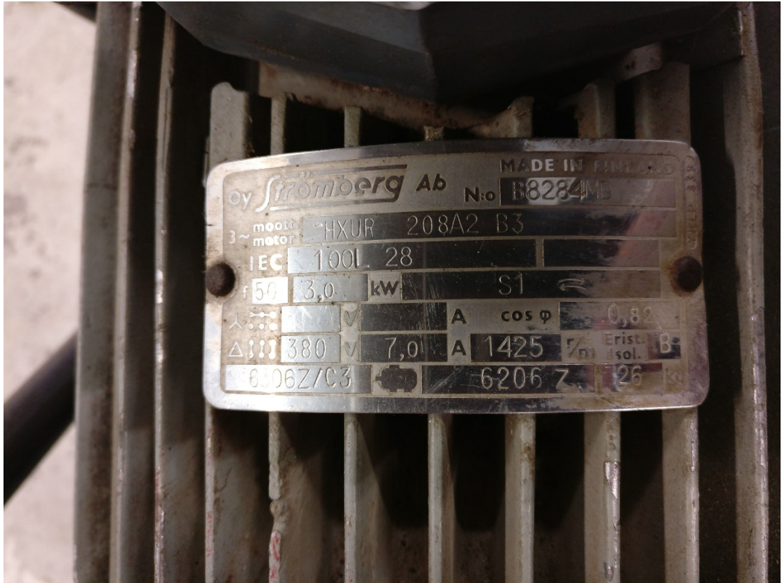
Kuva 5. Sähkömoottorin valmistajan tyypikilpi
