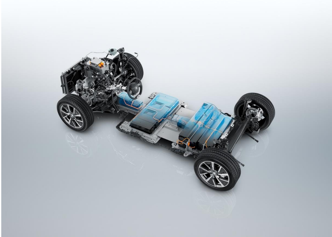
Kuva 1. Peugeot e-208:n uusi e-CMP-alustarakenne (Peugeot 2019b).
