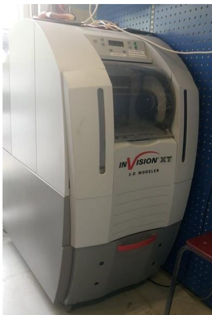
Kuva 19. InVision XT Rapid Prototyping Machine eli 3D-tulostin XAMK:n materiaalitekniikan laboratoriossa Mikkelissä, Markova 27.09.2019
