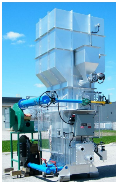
Kuva 10 Thermfire 2000 leijupetiuni (Sappinen 2018).
