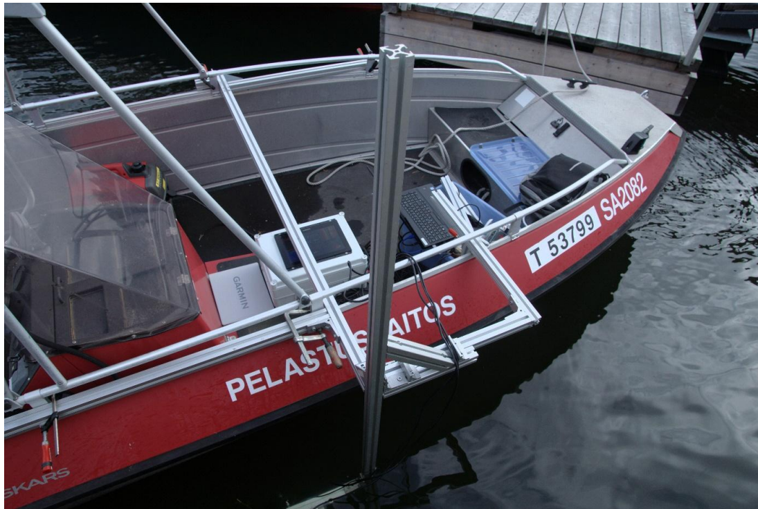
Kuva 11. Datankeräyslaitteisto veneeseen kiinnitettynä
