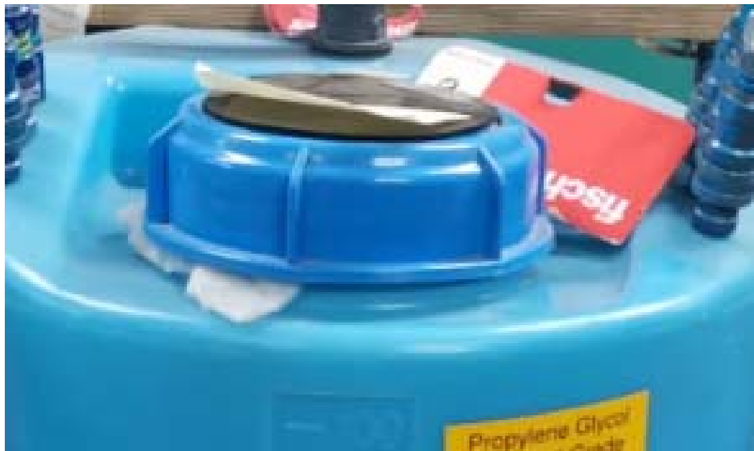
Kuva 5 Säiliön huohottimena toimiva korkki
