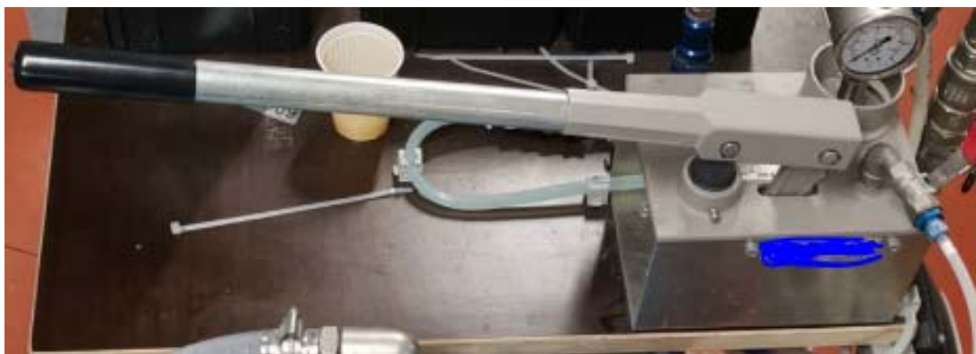
Kuva 3 Käsipumpuna eli koepainepumpuna käytetään ”Rothenberger RP 50 S.” -koepainepumppua.
