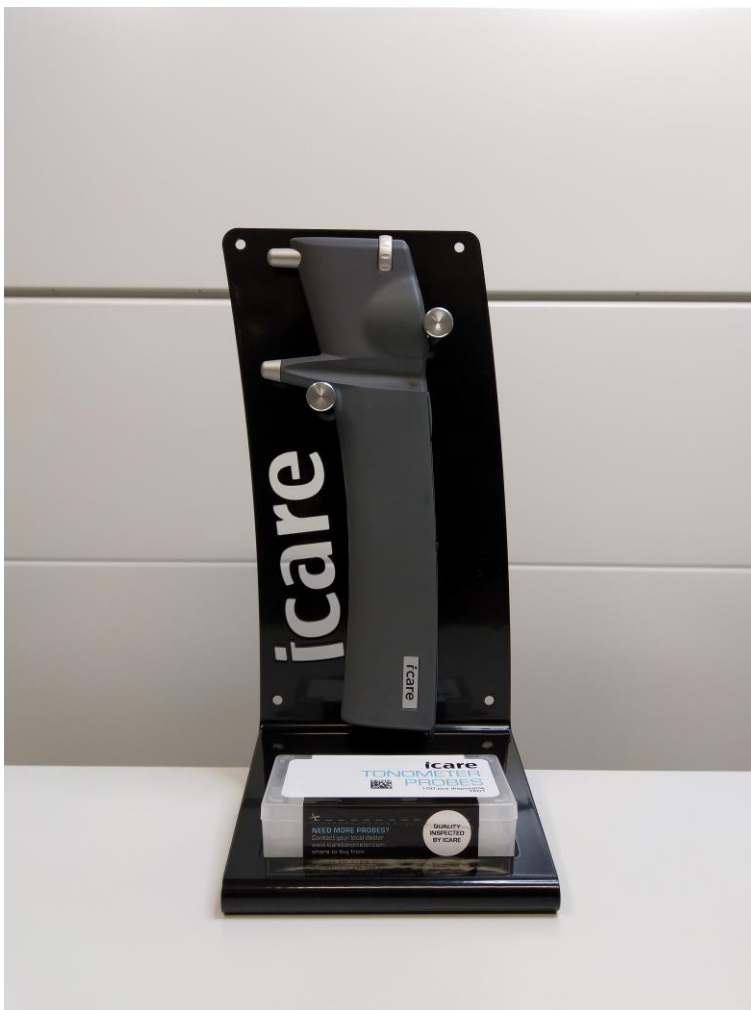
Kuva 10. Icare TA01i -silmänpainemittari ja anturilaatikko, otsatuen etäisyysäättö minimiasennossa.
