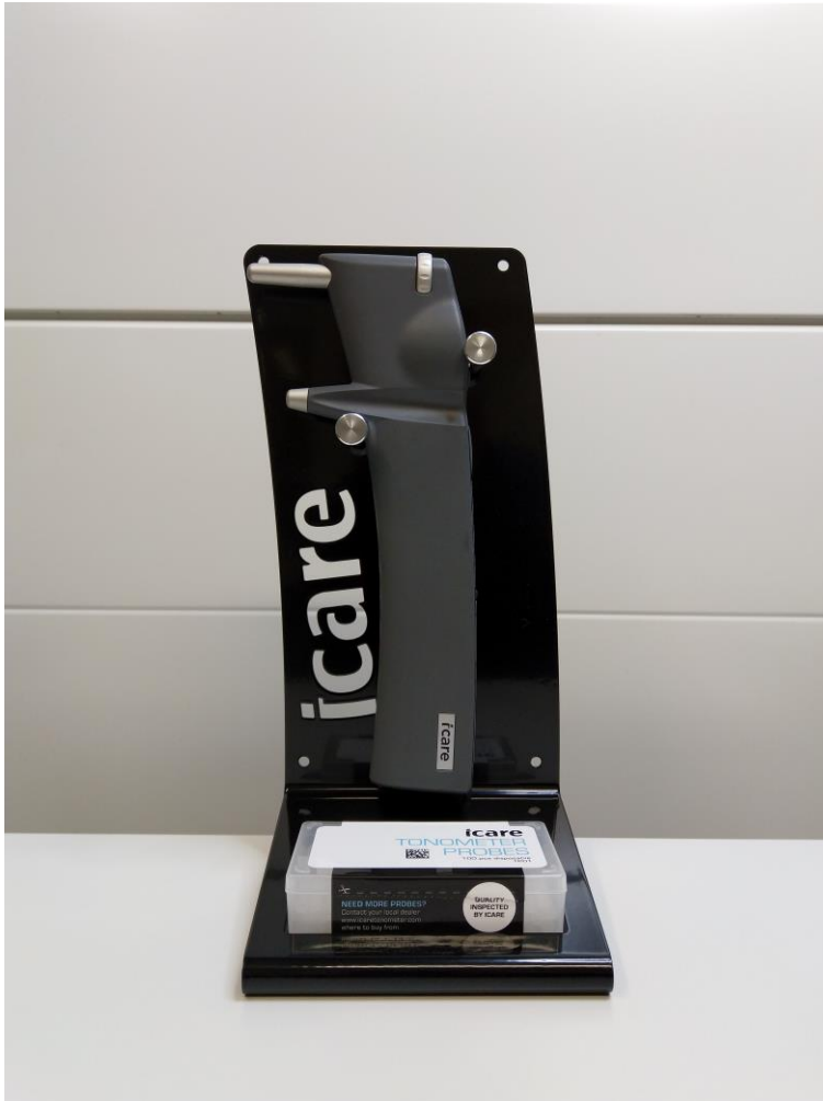
Kuva 11. Icare TA01i -silmänpainemittari ja anturilaatikko, otsatuen etäisyyssäätö maksimiasennossa.
