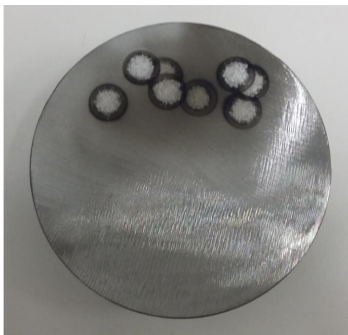
Kuva 12. OES-analyysin aiheuttaman polttojäljet X10CrMoVNb9-1-vertailupalan pinnassa.
