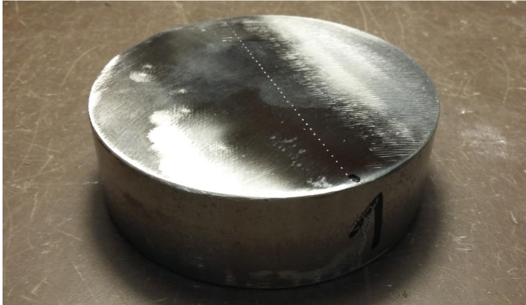
Kuva 2. Pöytäkovuusmittarin aiheuttamat mittausjäljet kappaleen pinnassa.
