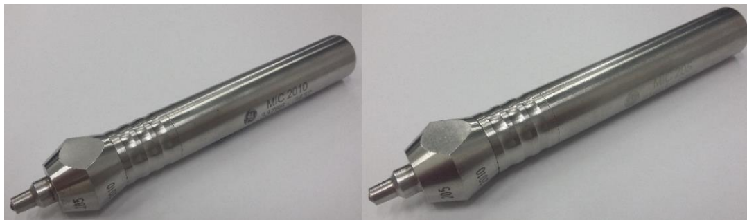
Kuva 11. Käytetyt anturit MIC10-kenttäkovuusmittarilla, vasemmalla 98 N ja oikealla 49 N.
