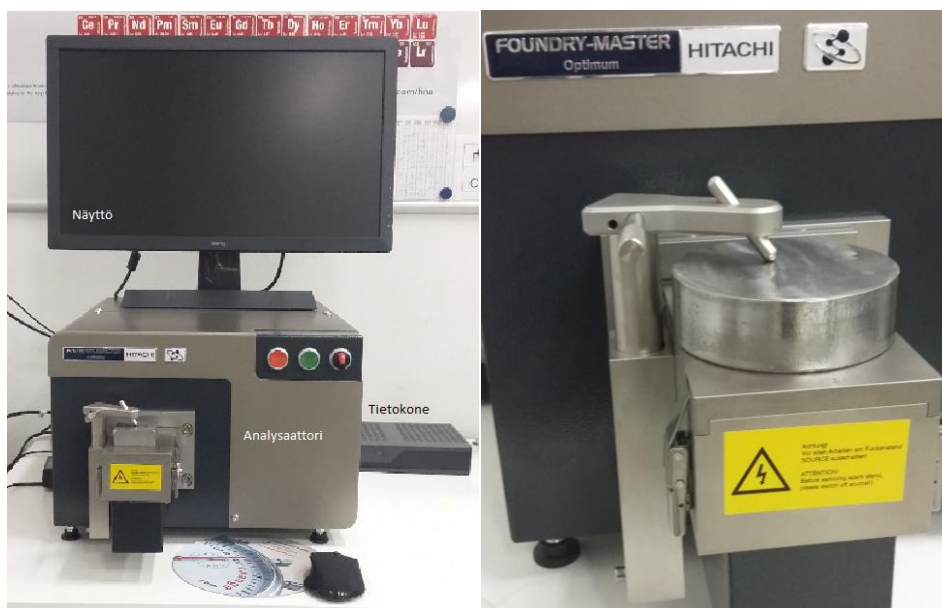
Kuva 13. Hitachi Foundry-Master Optimum; OES-analysaattori ja näyttöet otto.
