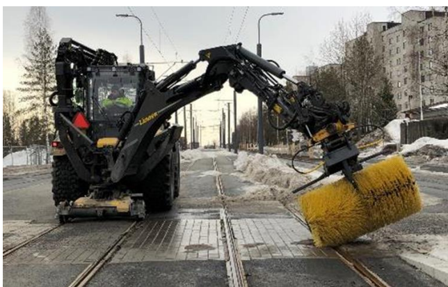
KUVA 7. Suojatien ja raiteiden putsaamista takaharjalla (Kunnossapitoallianssi n.d.)
