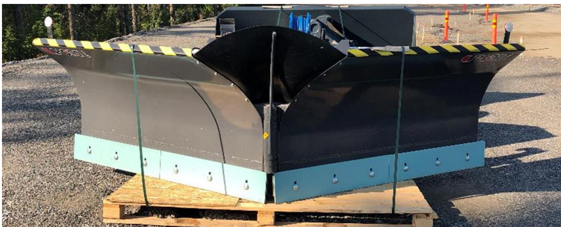
KUVA 5. Nykyinen nivelaura (Kunnossapitoallianssi n.d.)
