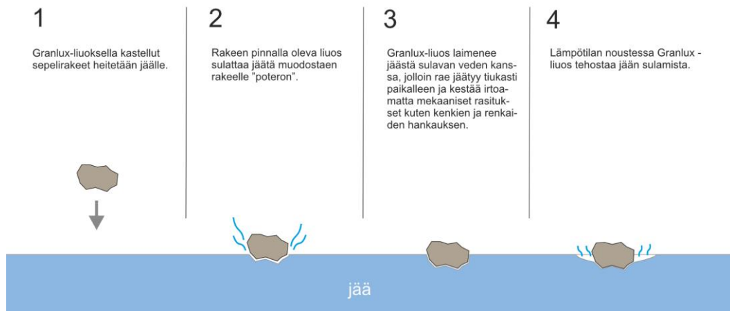
KUVA 12. GranLux rakeen toimintaperiaate (HPP Europe)
