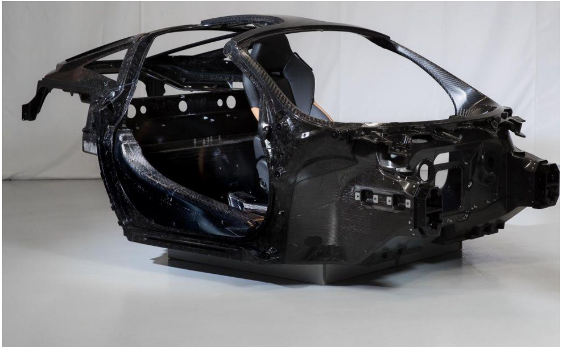
Kuva 2. McLarenin kehittynyt Monocage II -monokokkirakenne, joka valmistuu alle neljässä tunnissa (13).
