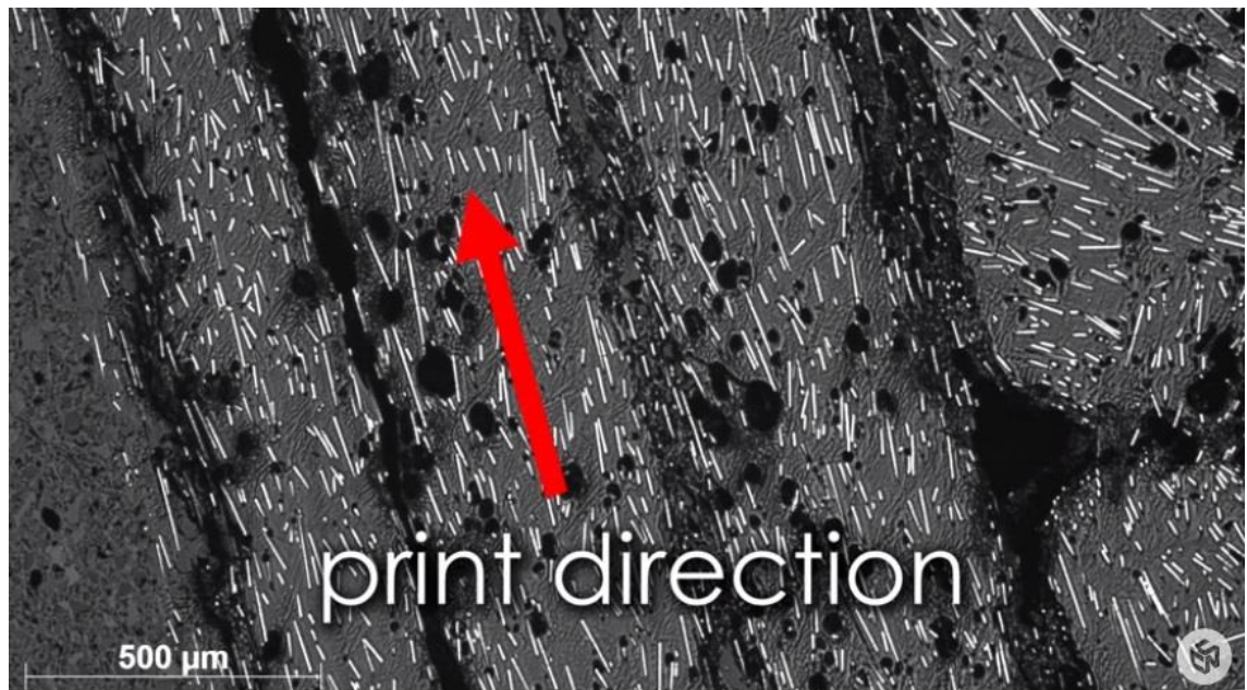
Kuva 13. CF-PLA-muovin lyhyet hiilikuidut kulkevat materiaalissa printtaussuunnan mukaan. Skaala mikrometreissä (109).
