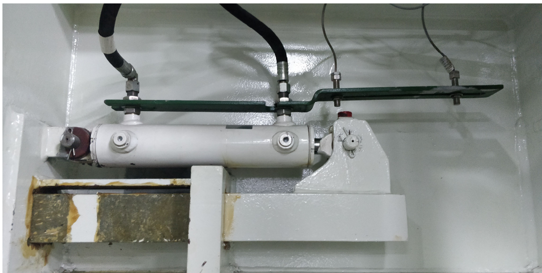
Kuva 2. MV Traviatan lastirampin hydraulinen lukitus magneettisilla rajakytkimillä (Taimisto 2018).
