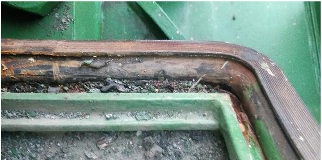
Kuva 1. Erittäin likainen tiivistekumi, joka päässyt myös vahingoittumaan partikkelien johdosta (Taimisto 2018).
