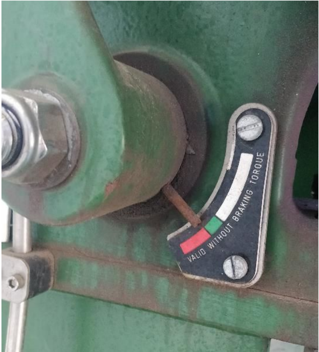
Kuva 8. Vinssin jarrun kuluneisuutta indikoiva mittari osoittaa jarrun olevan pian huoltokunnossa (Taimisto 2018).
