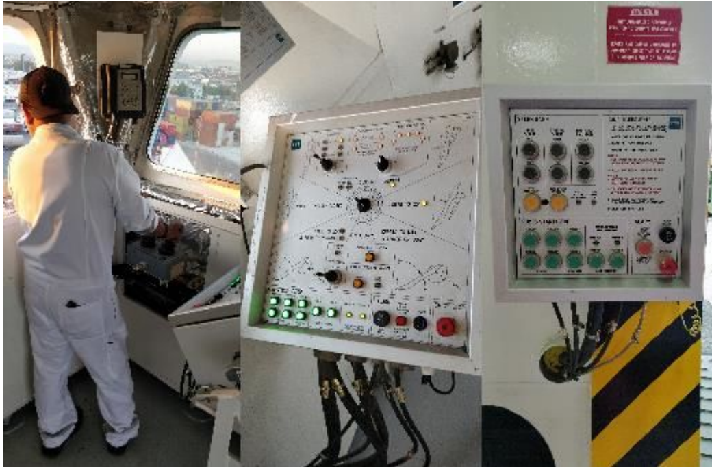
Kuva 14. Lastirampin ohjauksen testausta ja merkkivalojen tarkastusta (Taimisto 2018).
