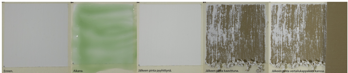
Kuva 9 Uula-maalinpoistoaine, 2,0 minuutin vaikutusaika.
