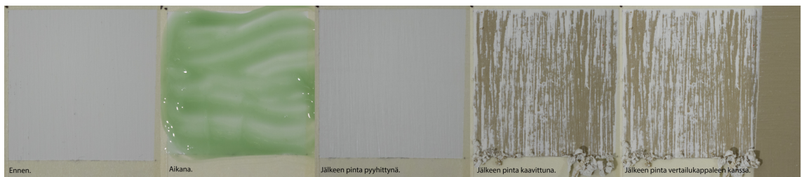
Kuva 13 Bio Comb, 3,0 minuutin vaikutusaika.
