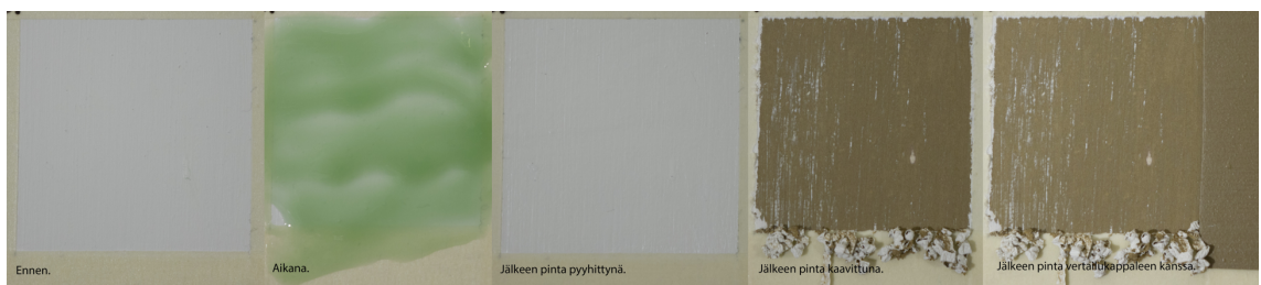
Kuva 10 Uula-maalinpoistoaine, 2,5 minuutin vaikutusaika.
