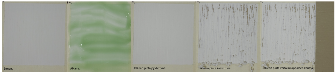
Kuva 11 Bio Comb, 1,0 minuutin vaikutusaika.
