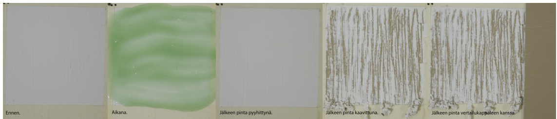
Kuva 12 Bio Comb, 2,0 minuutin vaikutusaika.
