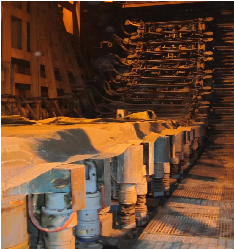
KUVIO 4. Jatkuvalukoneen 6 sektioista muodostuva kaareva osuus.
