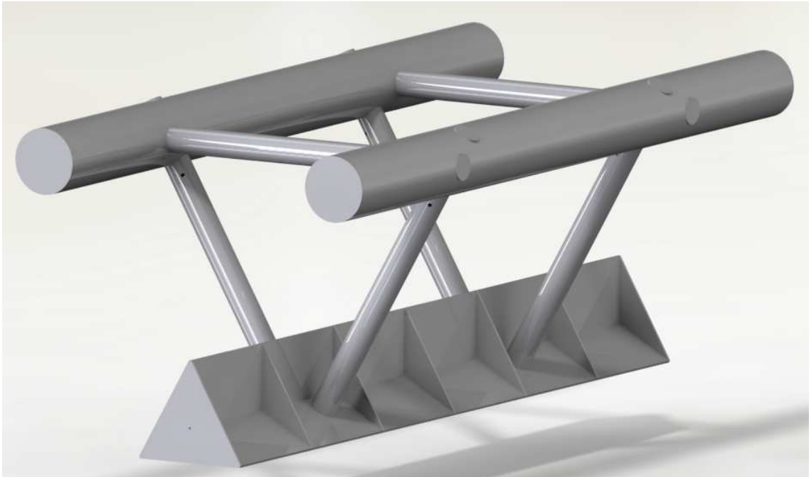
KUVA 2. Aallonmurtajaelementin rakenne, Mikael Laurila, 2019.
