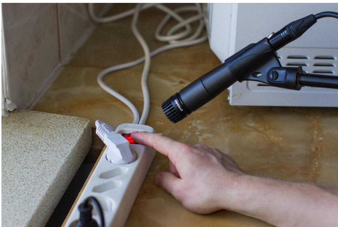
Kuva 4. Lähimikrofonitekniikka ja dynaaminen mikrofoni
