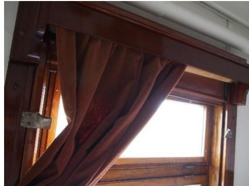
Vasemmalla kuvassa rullaverhon mekanismi verhon laskemista ja nostamista varten. Oikealla kuva samettiverhosta ja yläikkunan avaamista varten karmiin kiinnitetyt tuet.
