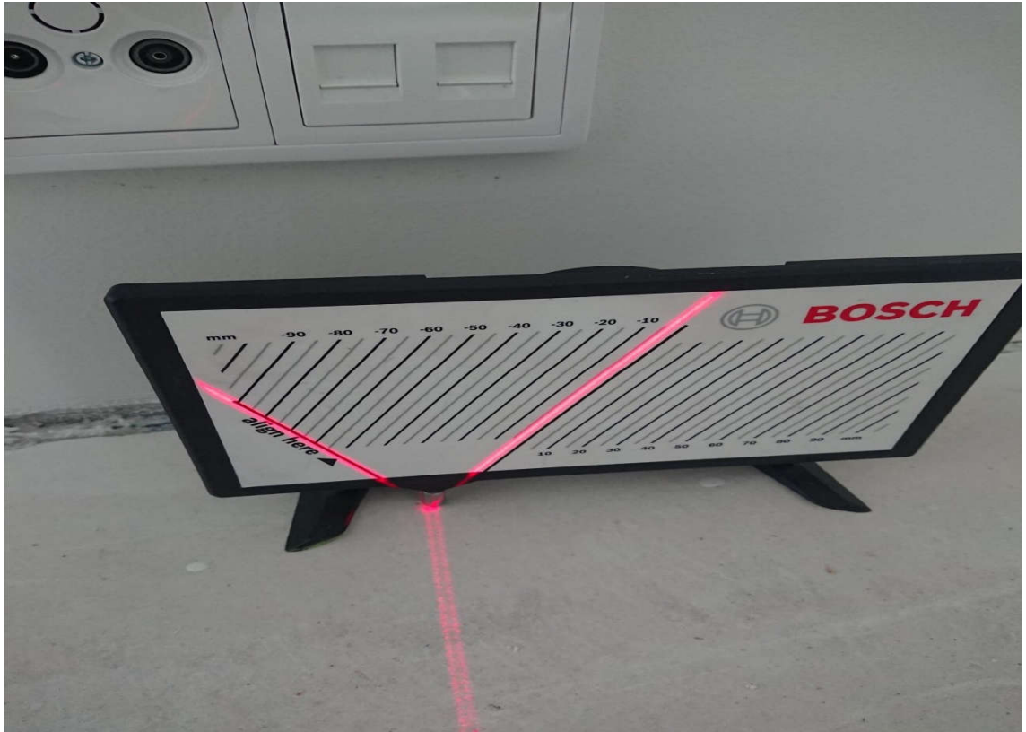
Kuva 9. Valupinnan tasaisuuden laadunvalvontaa. (YIT Suomi Oy 2019).
