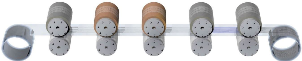
KUVA 1. Esimerkki rullalta rullalle painoprosessista [1]
