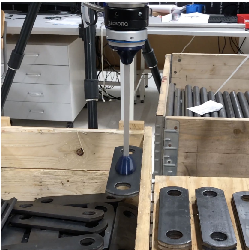
Kuva 12. Puulaatikon reunan käyttäminen levyn keskittämiseen
