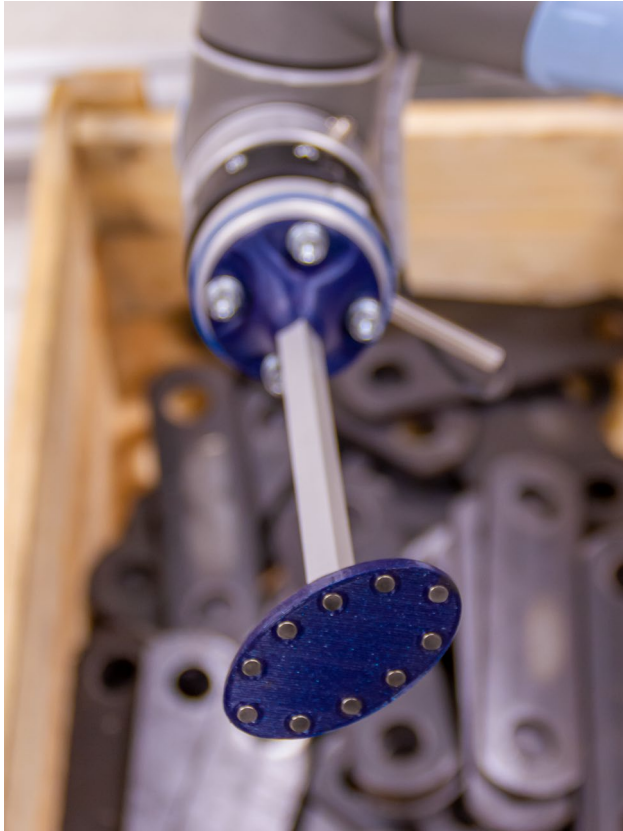
Kuva 11. Robotille tehty kestmagneettitarttuja
