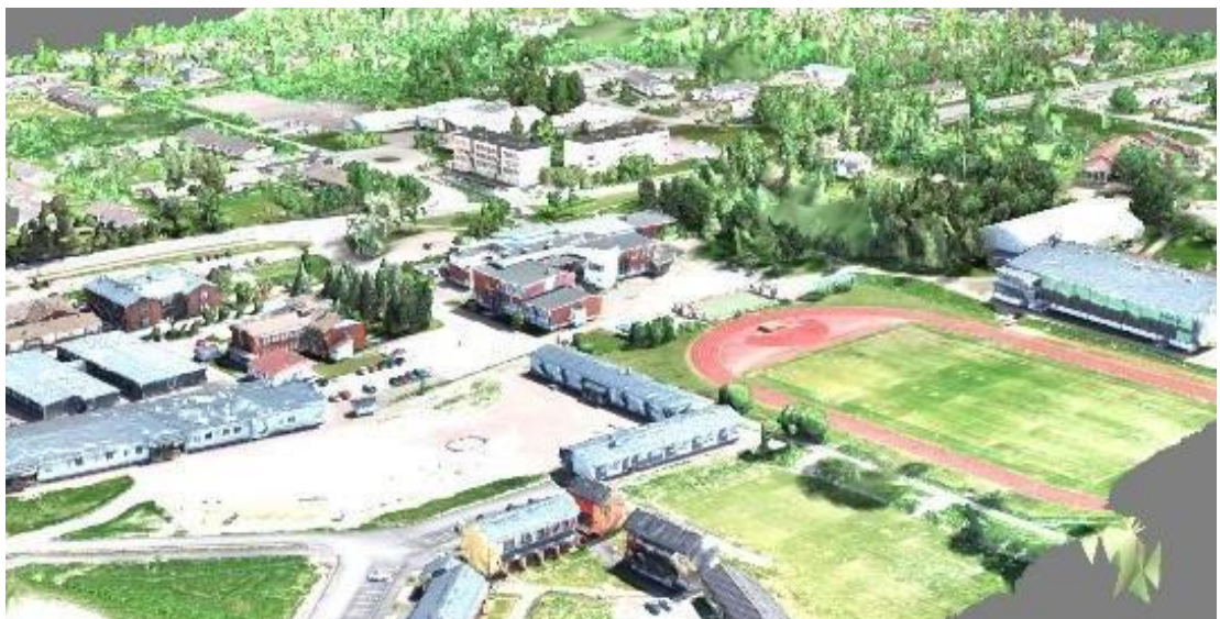
Kuva 17. Fotogrammetrialla tuotettu kaupunkimalli. (Sitowise 2019)
