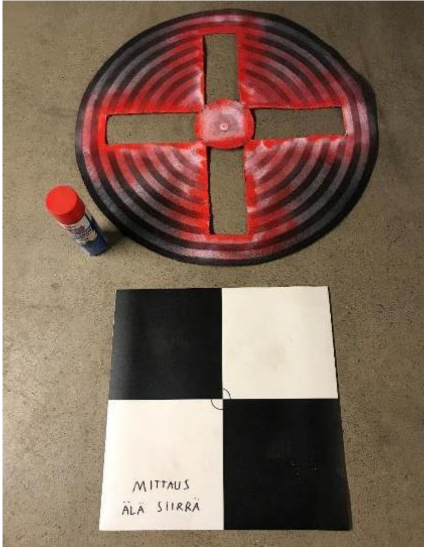
Kuva 15. Tähyks ja kohdistuspisteiden sapluuna. (Sitowise 2019)
