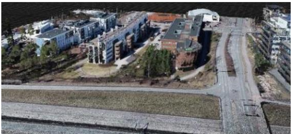
Kuva 16. Fotogrammetrinen pistepilvireferenssi. (Sitowise 2019)
