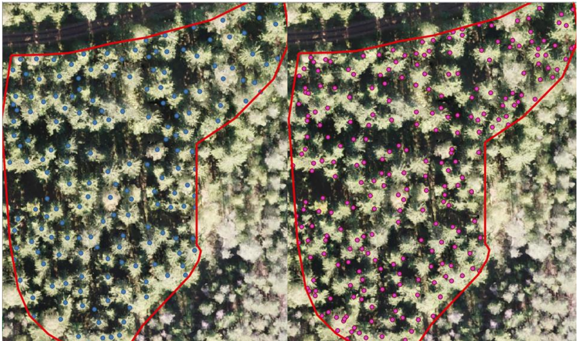
Kuva 11. Kuvion 367 dronen ortomosaiikki. Mosaiikin päällä drone- sekä laserkeilaus puukarttojen pisteet. Dronen pisteet sinisellä ja laserkeilauksen liilalla.
