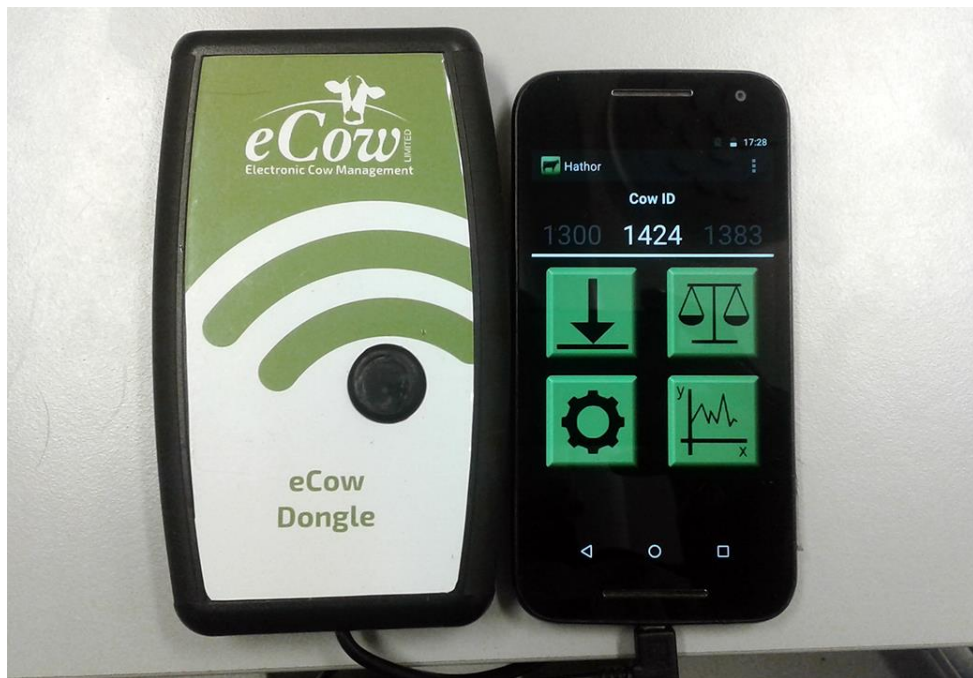
Kuva 8. Tietojen lataamiseen käytettävä eCow Dongle ja Hathor-sovellus.
