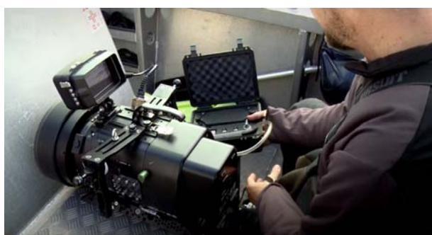
KUVA 7. Kameran Gates-sukelluskotelon alipaineistusta (Näin syntyi Järven tarina, 2017.)
