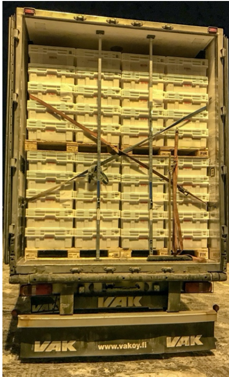
Kuva 6. Esimerkki tehokkaasti käytetystä kuormatilan tilankäytöstä kaukokuljetuksessa. Kuvassa elintarvikkeiden kuljetukseen tarkoitettuja Transbox-lihalaatikoita FIN-lavoilla (Lammin-taus 2018)
