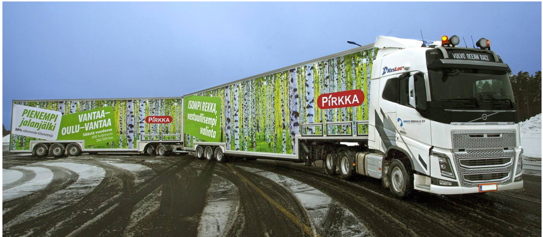
Kuva 8. Keskon ajossa oleva suurin, 34 metriä pitkä ja kokonaispainoltaan 90 tonnia oleva kaksitasoinen HCT eli High Capacity Transport-yhdistelmä, joka operoi Vantaa – Kempele väliä ajoneuvokohtaisella erityisluvalla (Keskolla on... 2015)
