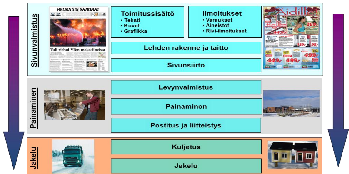
Kuvio 14. Sanomalehden valmistusprosessi (Sanomapainon esittelykalvot 2010).
