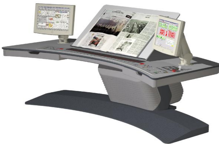
Kuvio 20. Painokoneen ohjausjärjestelmän ohjauskonsoli (Tiihonen 2002).
