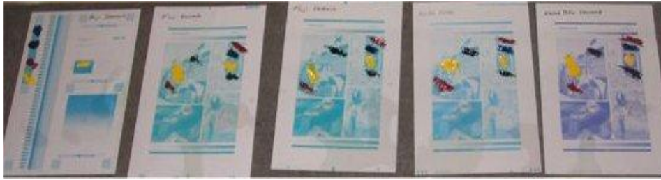
Kuvio 61. Testilevyjen tippatesti (Flintin värit ja Printcom lisäaineet).
