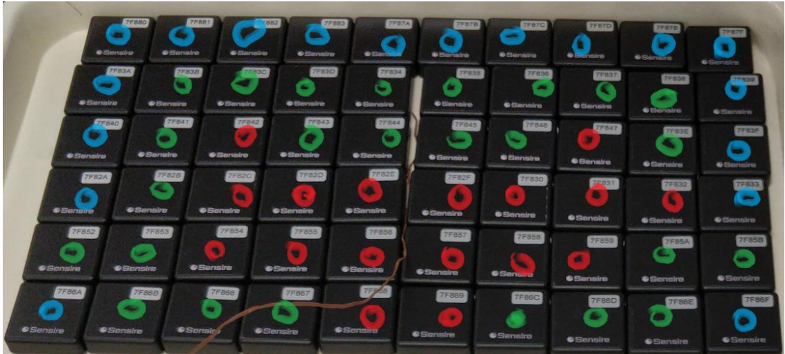
Kuva 6 Sensoreiden minimilämpötilojen jakautuminen jääkaapissa
