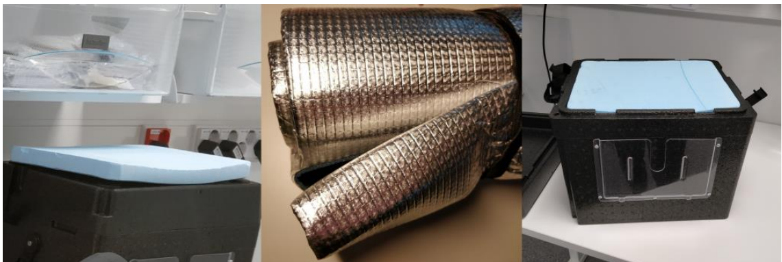
Kuva 4. Muotoon leikattu sininen muovi (vasemmalla), alumiinikerroksella päällystetty makuualusta (keskellä) ja sininen muovi tuplakantena (oikealla)
