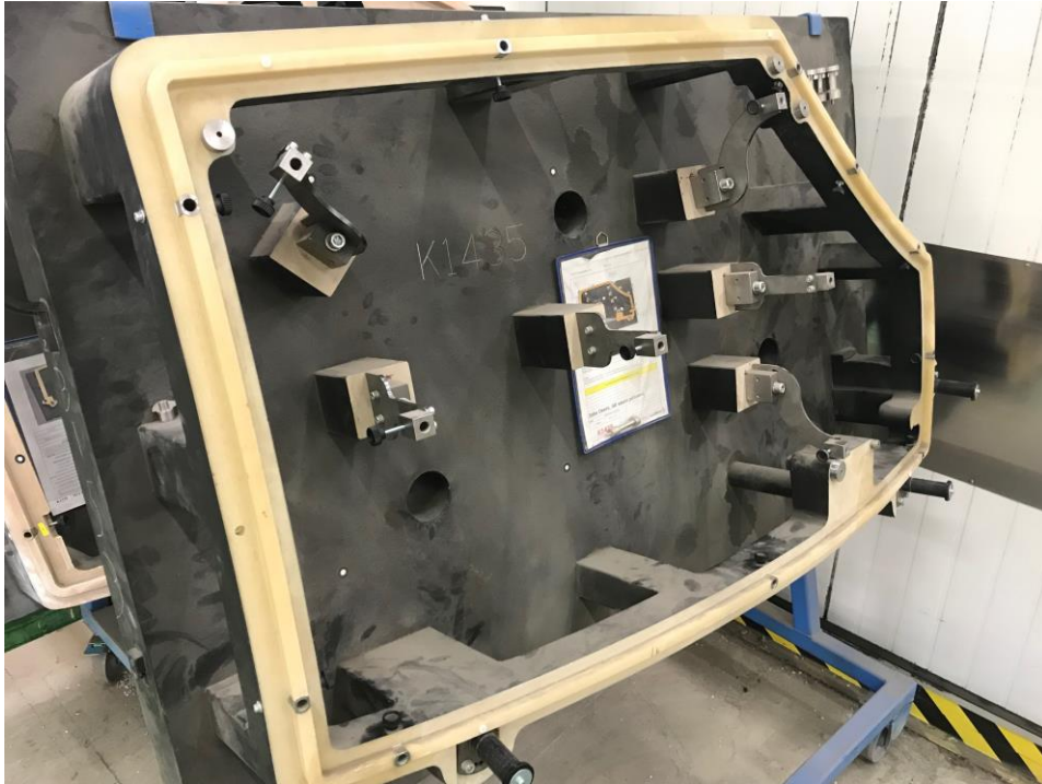
KUVA 2. Koneistettu tuotekohtainen koetinmalli. Koetinmallit ovat tyypillisesti asiakkaan omaisuutta.
