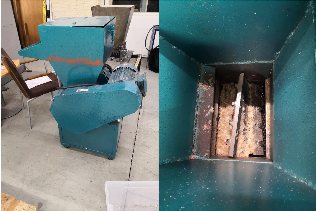
KUVA 24. Vasemmalla vertailusilppuri ja oikealla sen teräakseli
