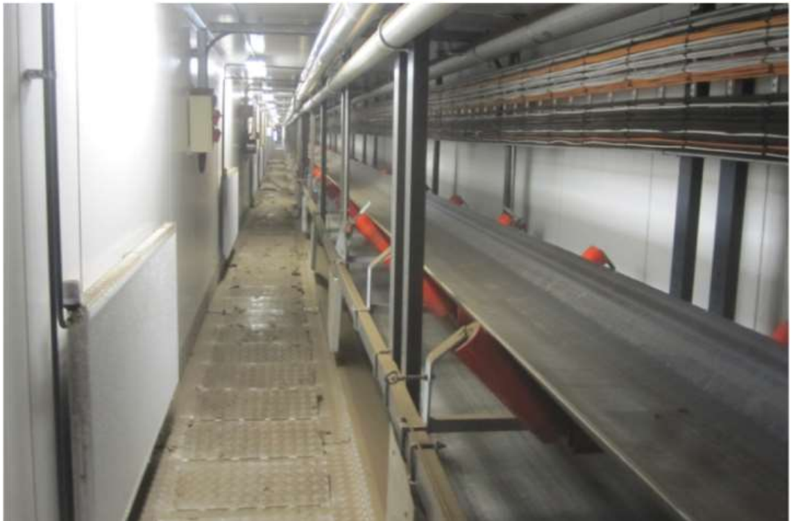
Kuva 19. Lämpöeristetty umpikuljetinsilta, kulkutaso sekä hihnakuljetin.
