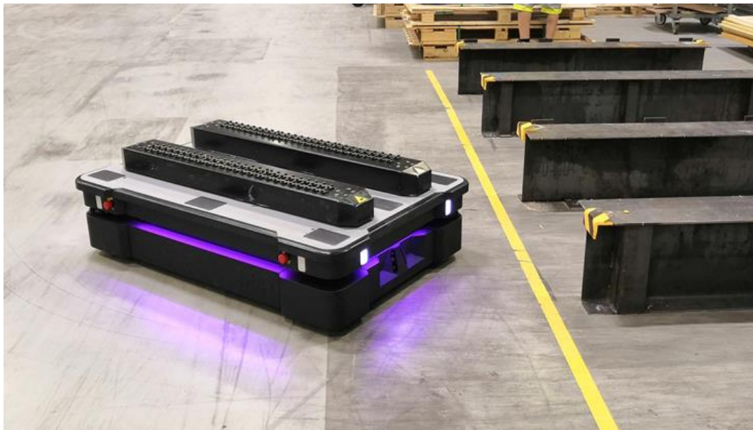
Kuva 6. MIR1000 jumissa telakoitumisvaiheessa.
