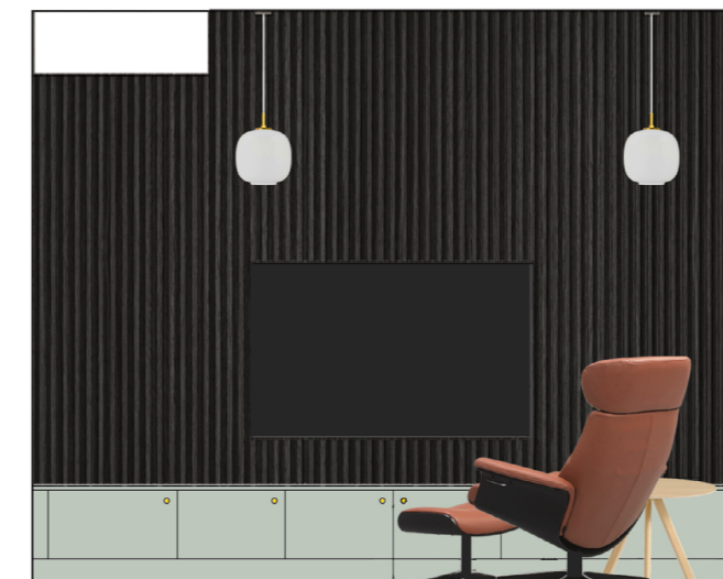
Projektio takkahuoneesta rimoitusseinältä. Vasemmassa yläreunassa on talotekniikan kotelointi.
