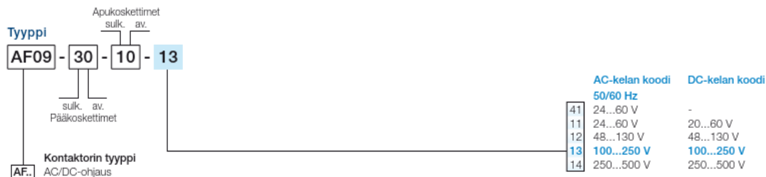
Kuva 14. AF-kontaktorin keläjännitekooditaulukko (ABB:n tuotekatalogi 2016)
