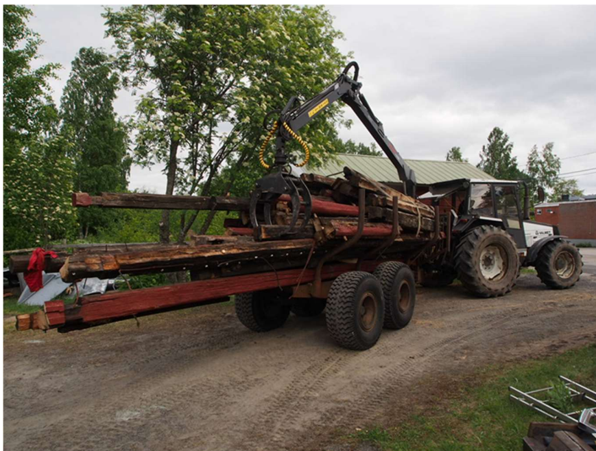
Kuva 12. Hirsien siirtoa metsätraktorilla, hirret sidottu tukevasti liinoilla (Repo 2019).
