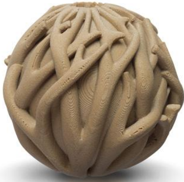
Kuva 5 Erilaisia kappaleita ja käyttöesineitä, jotka on valmistettu puupohjaisesta materiaalista lisäävällä valmistuksella. (3D-systems)
