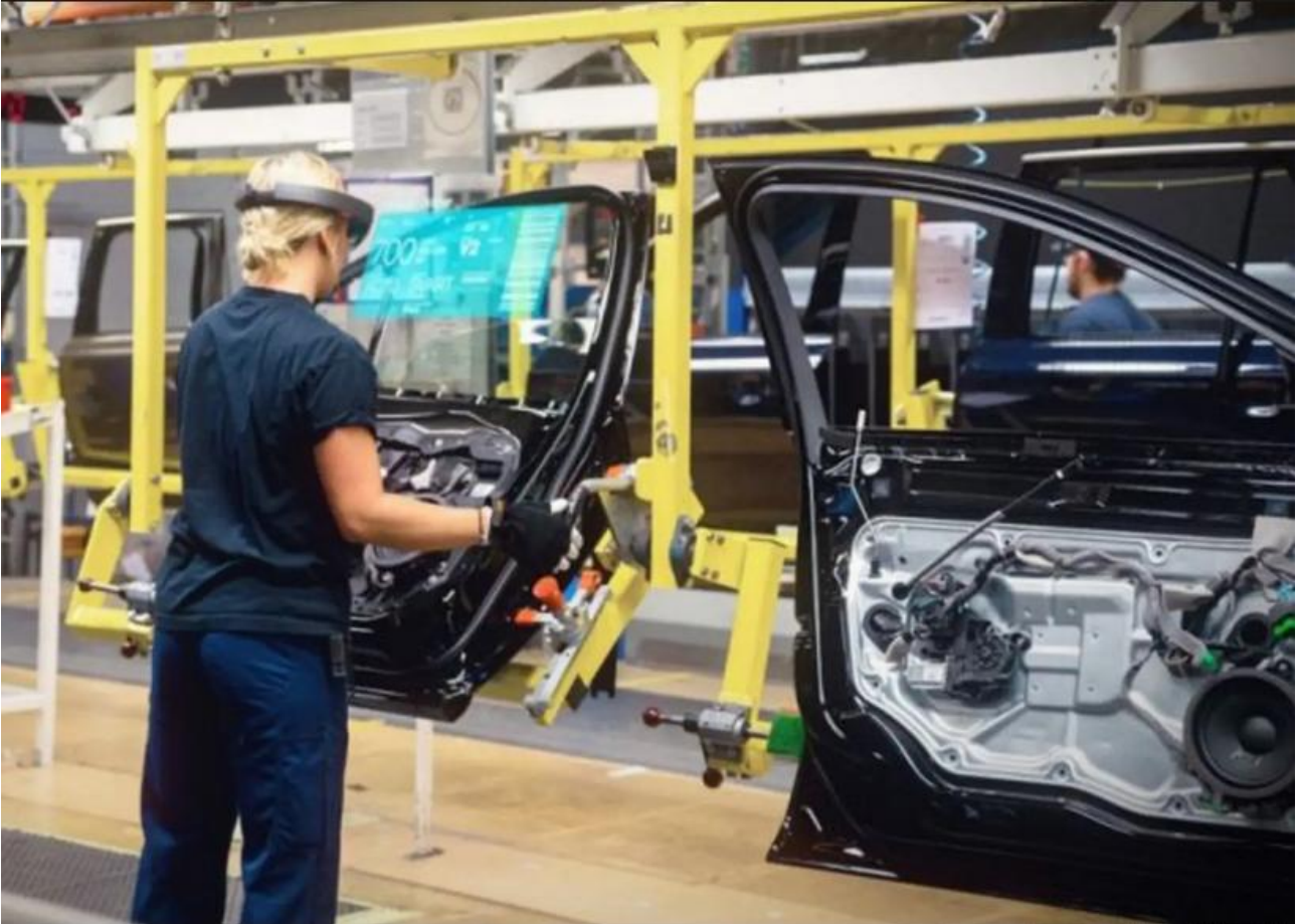
Kuva 1. Volvo on käyttänyt HoloLens-laseja oman lisätyn todellisuuden ratkaisussaan kokoonpanolinjallaan.
