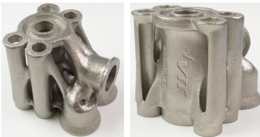
Kuva 5 3D-tulostuksella valmistettu hydraulilohko (VTT&Nurmi)
