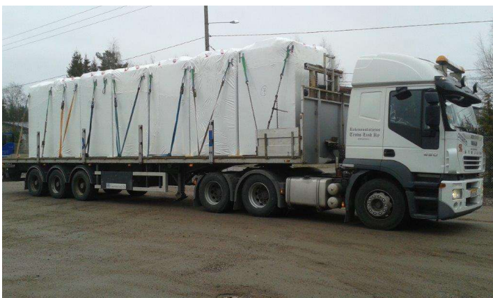
KUVA 2. Elementit valmiina toimitukseen työmaalle. (Rakennusbetoni- ja Elementti Oy)
