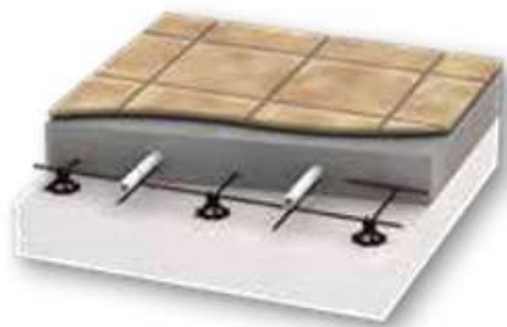
17 mm ja 20 mm putki betonirakenteessa.
