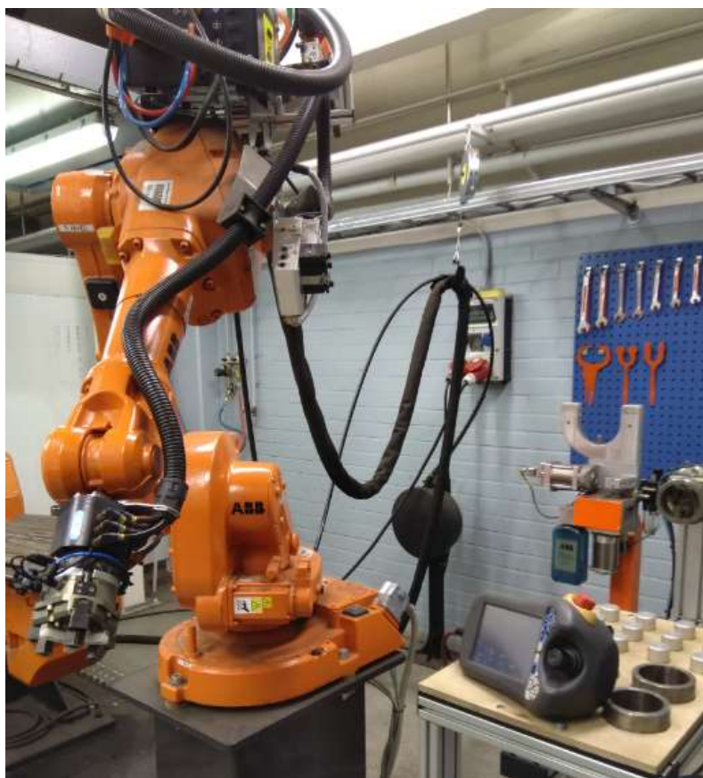
KUVA 4. Nivelrobotti varustettuna kappaleenkäsittelyyn soveltuvalla tarraimella
