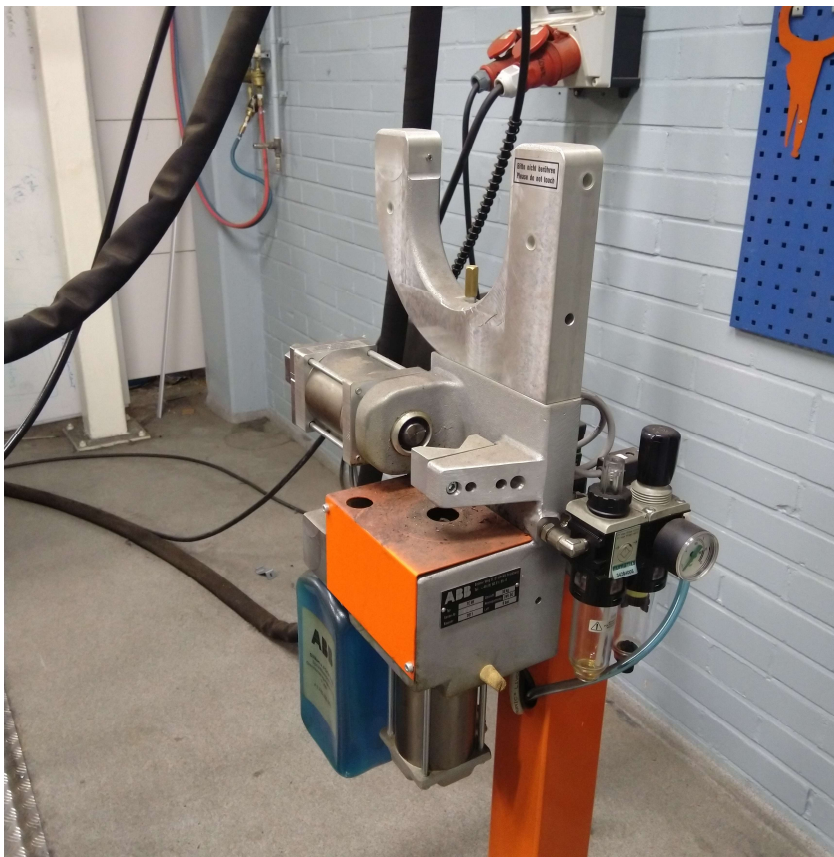
KUVA 5. Työkalujen paikoitus ja hitsaussuuttimen puhdistuskeskus
