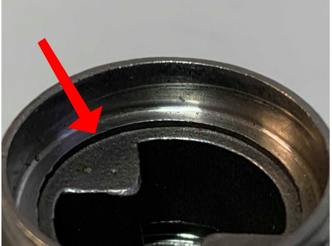
Kuva 10. Koneistusvirhe lukon käyttökarrassa.
