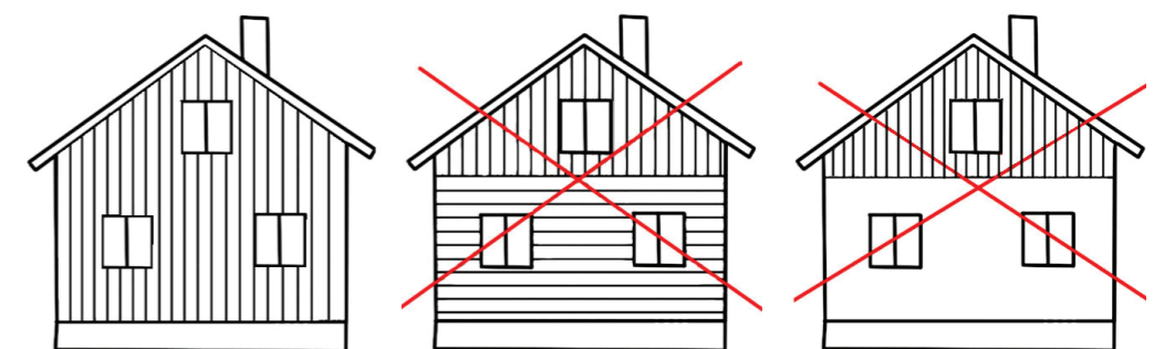
Kuva 68. Laidoitus tai rappaus on yhtenäinen koko julkisivun pituudelta.
