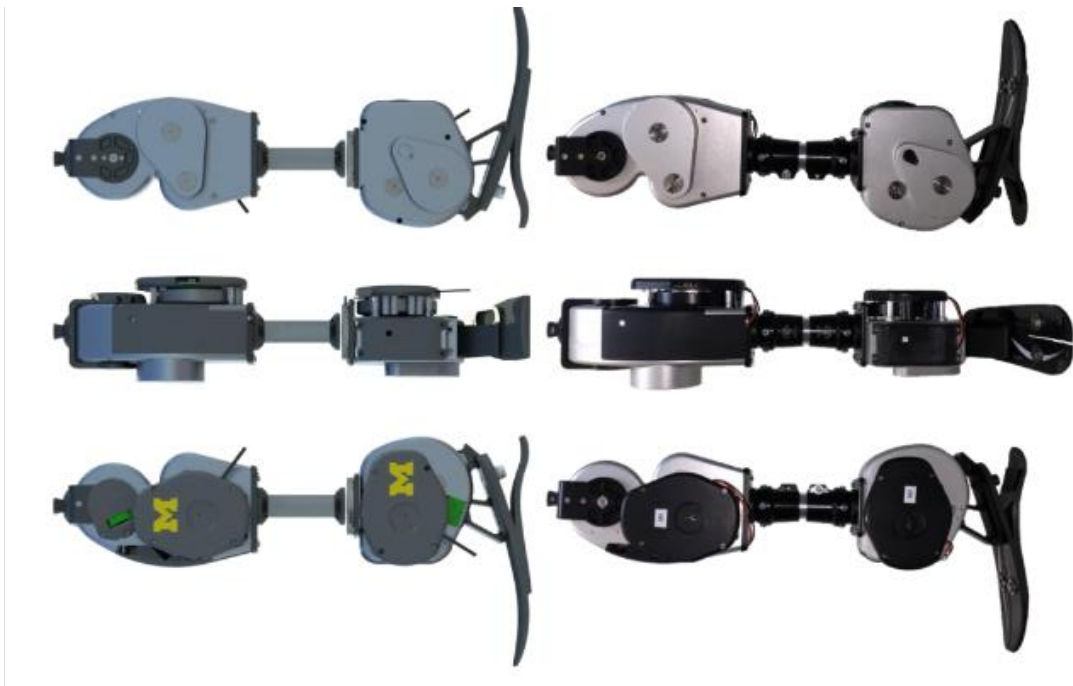
Kuva 28. OSL-proteesin mallinnettu (ylin kuva) ja fyysinen (alin kuva) havainnekuva (Azocar ym. N.d.)
