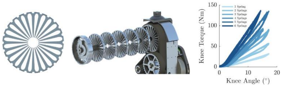
Kuva 27. Yksittäinen jousilevy kuvattuna edestäpäin (vasen). Irto-osakuva jousilevyistä proteesin sisällä (keskellä). Kuvaaja vääntövoiman ja kulman suhteellisuudesta eritasoisilla jäykkyyksasteilla (oikea). (Azocar ym. N.d..)
