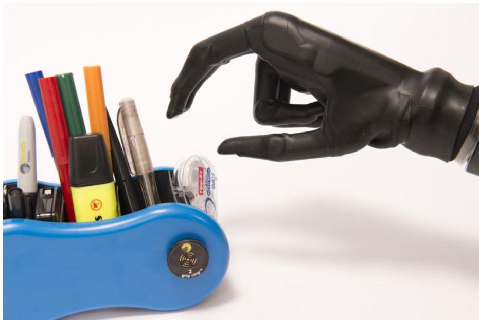
Kuva 20. Grip Chip sijoitettuna kynärasiaan (Össur www-sivut 2019)
